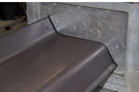
Выдавливание профиля Geoflex
