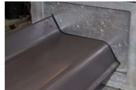
Extrusión de un perfil de Geoflex
