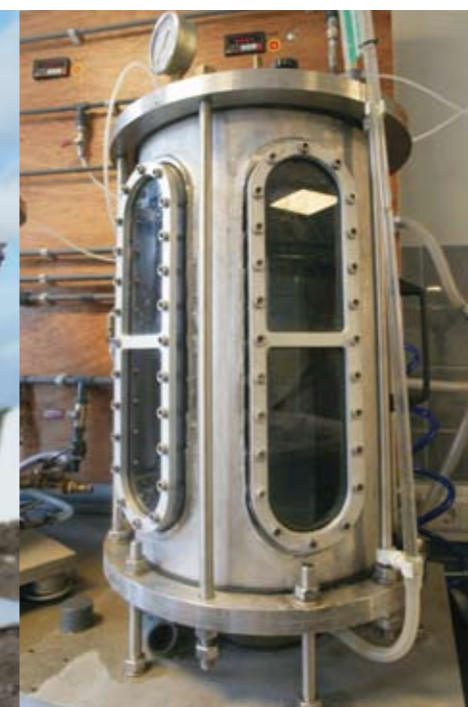
Réceptacle à pression utilisé pour tester les drains verticaux (test de Delft)
