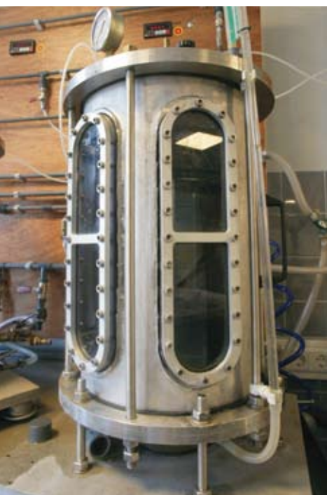
Zum Testen der Vertikalabläufe benutzter Druckbehälter (Delftse-Test)
